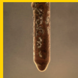
Korrosion mit herkömmlichem Diesel 1
